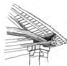
Liaison d'une charpente traditionnelle avec un poteau en pierre
